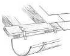
Gouttière pendante posée en débord et sous l'égoût de toit.
