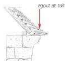
B - Réalisation d'un drainage périphérique de la construction en l'absence ou en complément de gouttière.
