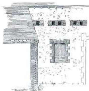
Maçonnerie mixte, enduit et brique - tuiles plates en terre cuite, - chaîne d'angle et encadrements de baie en brique, - enduit à pierre vue en arrière plan, - enduit couvrant au premier plan.
