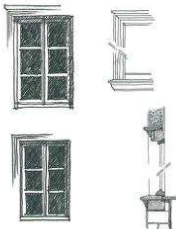
Différents modèles anciens, en façade et en coupe, d'encadrements de baies en bois.
