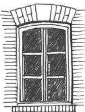
Fenêtre à deux ouvrants, découpés chacun en trois carreaux.
