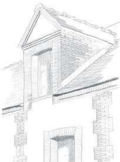
Lucarne, encadrement de baie et chaînes hâchées en brique appareillée à Brezolle.
