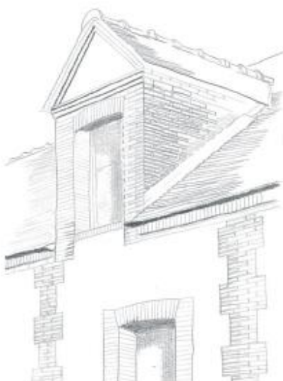
Lucarne, encadrement de baie et chaînes harpées en brique appareillée à Brezolle.
