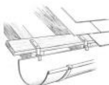
Gouttière pendante posée en débord et sous l'égout de toit.
