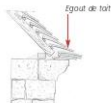
Les égouts de toiture présentent une rupture de pente ici créée par la superposition de tuiles sur la corniche.
