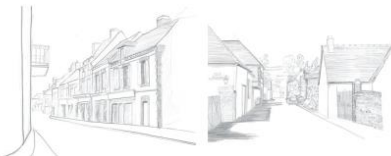
En l'absence de mitoyenneté, de hauts murs de clôture en maçonnerie maintiennent la continuité du front bâti.
